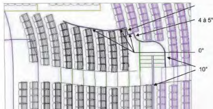
Les fronts de balcon seront convexes en coupe, avec un rayon de courbure de l'ordre de 5,5 m.
